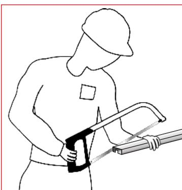
**7** - Ajuster le dernier tronçon en sciant l'excédent.
