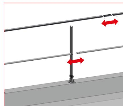
**6** - Assembler les mains courantes avec les jonctions et les sous-lisses des tronçons montés. Fixer chaque jonction avec les vis 4,8 x 16 : 2 à chaque jonction de main-courante et 1 entre 2 sous-lisse.
