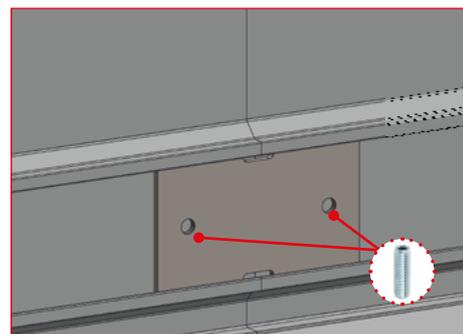
**1** - Tourner d'un quart de tour le support de plinthe entre les rainures de la plinthe, et placer la patte du support contre la partie droite de l'embase. Fixer le support au montant et à la plinthe comme indiqué ci-dessus avec 1 vis autoforeuse T25 4.8 x 32 et 1 vis cuvette M8x10.
